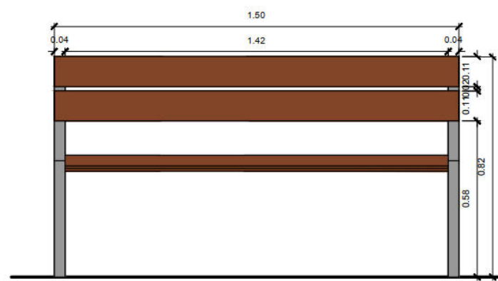
DETALHE BANCO MADEIRA (elevação frontal) Escala 1:20
