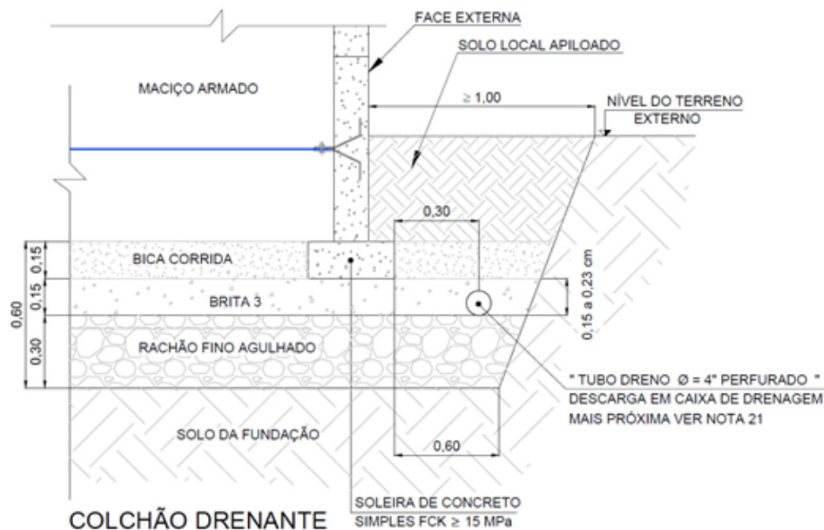
Figura 05 – Detalhe do colchão drenante.
