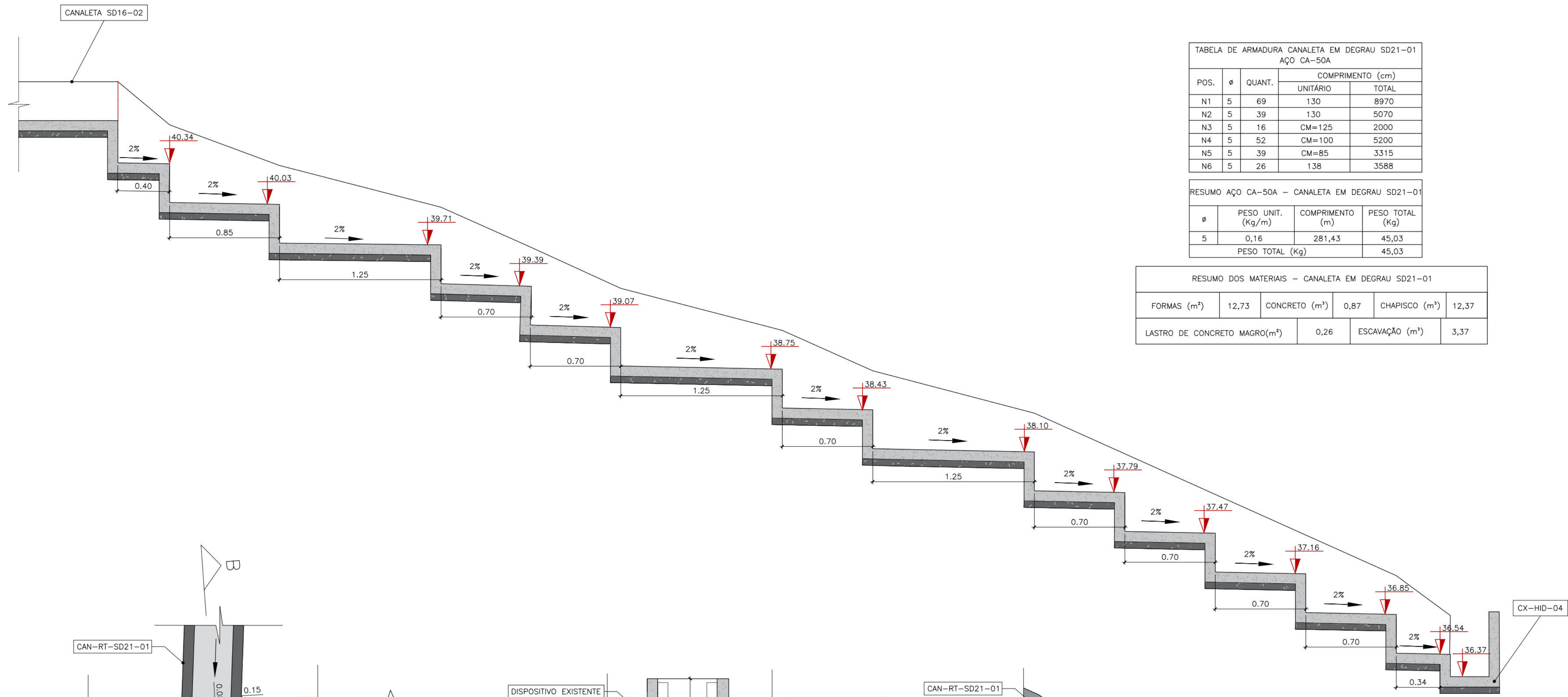
DETALHAMENTO DE FÔRMA CANALETA EM DEGRAU SD-21 ESCALA 1:20
