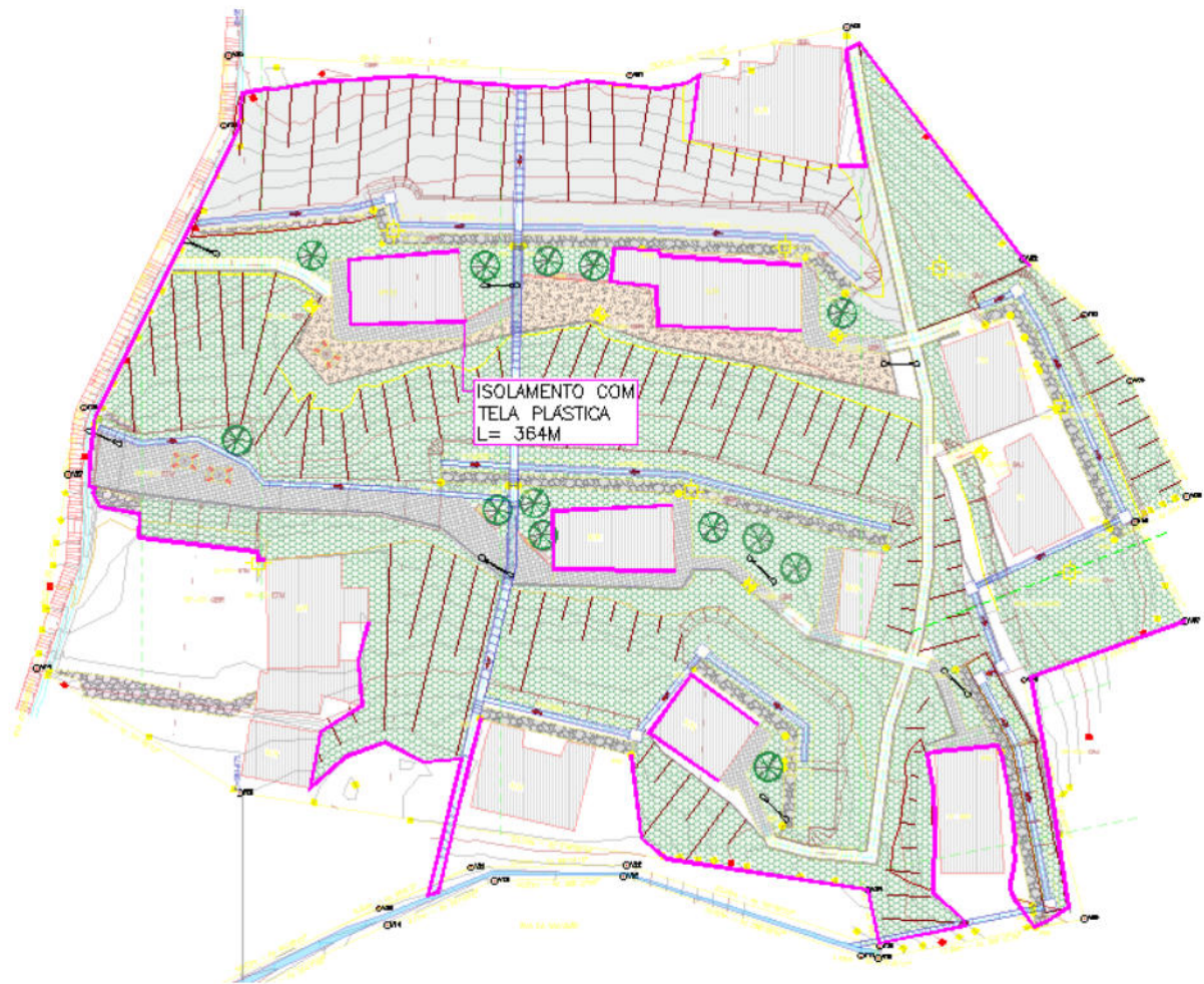
Figura 4: Isolamento com tela plástica- Rua da Goiabeira - RPA 2, Recife – PE.
