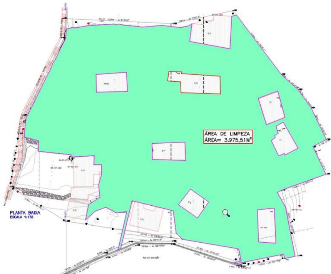
Figura 7: Área de limpeza manual de terreno - Rua da Goiabeira - RPA 2, Recife – PE.
