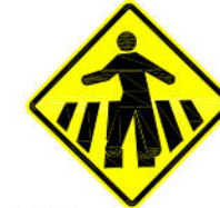
A - 32b PASSAGEM SINALIZADA DE PEDESTRES
