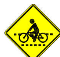
A - 30b PASSAGEM SINALIZADA DE CICLISTAS
