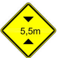
A - 37 ALTURA LIMITADA
