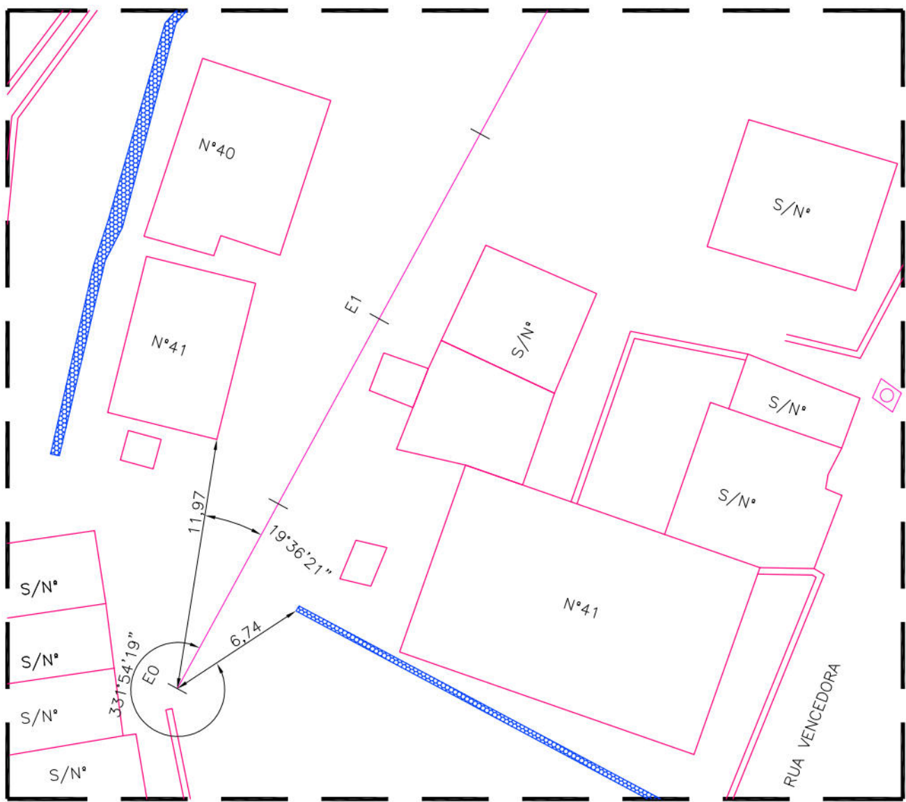
DETALHE DA AMARRAÇÃO ESCALA: 1/250
